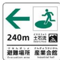
a) 方向矢印、避難場所図記号及び災害種別一般図記号（1種類）を組み合わせた避難誘導標識の記載例
