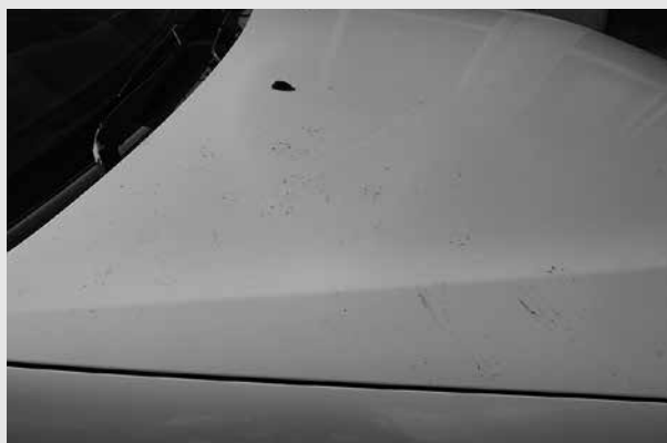
車両への粉塵被害
