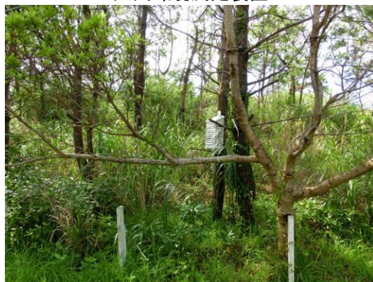
百葉箱内に温湿度センサーを設置
